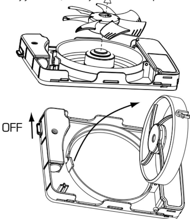
Usuń z kanału/rury nagromadzone zanieczyszczenia. W przeciwnym wypadku zachodzi ryzyko, że wentylator będzie pracował ze zmniejszoną wydajnością.
