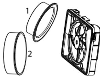
Wentylator można również zainstalować i użytkować bez przejściówek, tak aby był umieszczony bezpośrednio na powierzchni np. w przypadku kanału o średnicy mniejszej niż Ø 98
